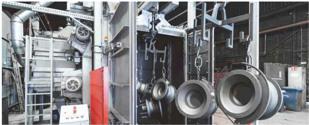
Beschichtung. Das Strahlmittel wird stets gereinigt und wieder eingesetzt.
